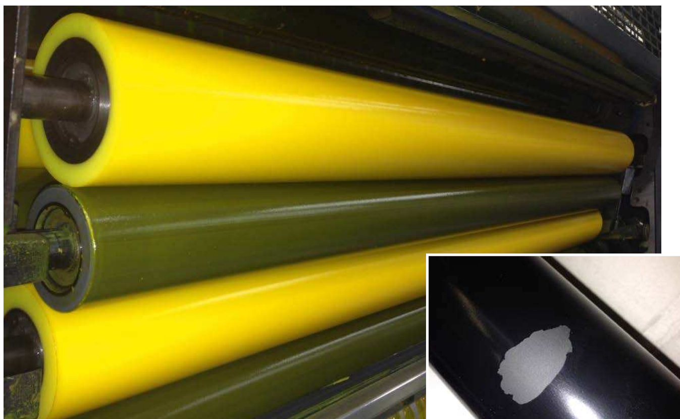
Bild 3+4: DURAPRINT-Walzen nach ca. 2 Jahren Laufzeit (links) und Walze mit Funktionsbeschichtung nach ca. 3 Wochen Laufzeit (rechts)
